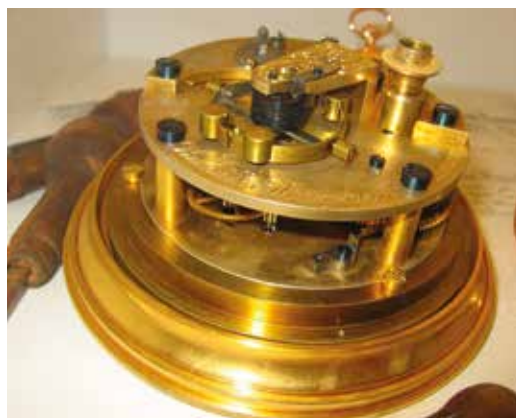
Links: Ein Union Marinechronometer. Das Rohwerk wurde von der Fa. Paul Stübner geliefert.
