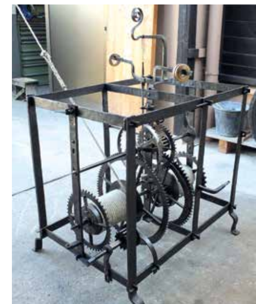
Testlauf fertiges Gehwerk im Hof.
