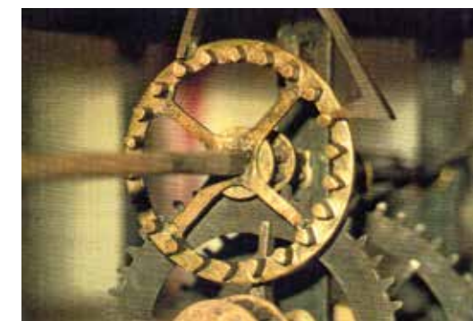
Hakengang ungleicher Anker mit rückfallender Hemmung.
