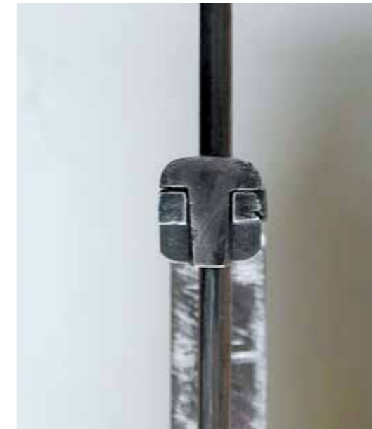
Hammerfederverkeilung Links: Spies Rechts: Stahlschmidt
