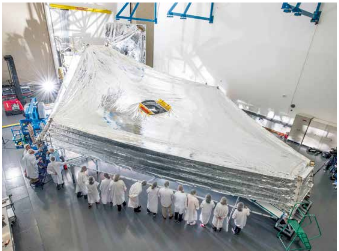
Test des Sonnenschildes 2014 im Werk von Northrop Grumman (@wikipedia.org). Auf diesem Foto sind die Größenverhältnisse gut zu erkennen.
