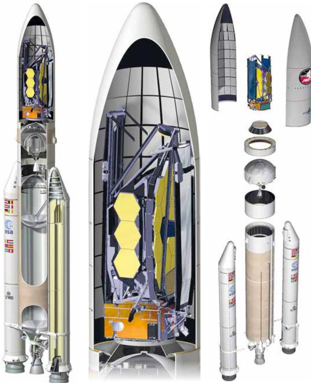
Aufbau der Ariane 5 und Unterbringung des Teleskops
